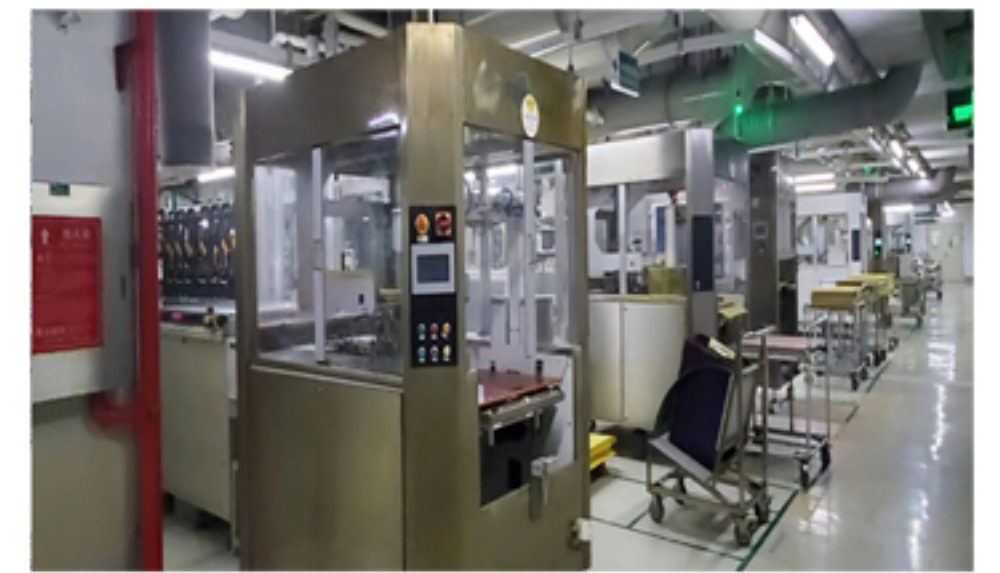
内层前处理线配备防护装置，防止设备异常造成伤害，并减少噪声
